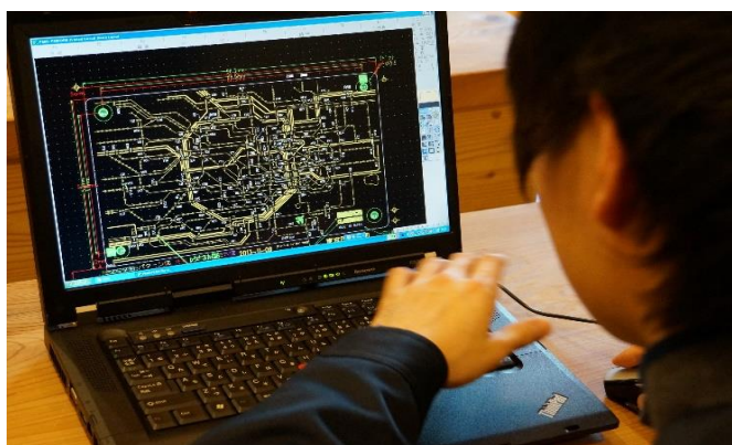
デザインソフトではないプリント基板用CADで設計
